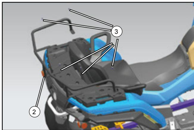
// Placez la rallonge de porte-bagages arrière (2) sur le support trous, puis insérez les vis (3).
